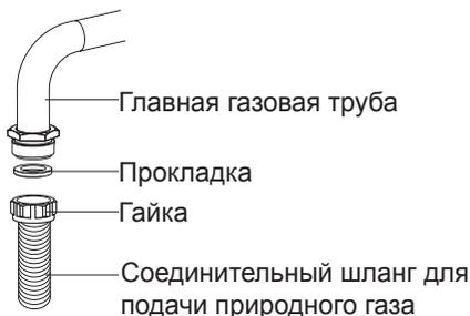
**2.** Подключение природного газа должен выполнять персонал специализированной службы. При подсоединении природного газа поместите прокладку в гайку на конце шланга для подсоединения природного газа. Для установки шланга на главную газовую трубку закрутите гайку.
