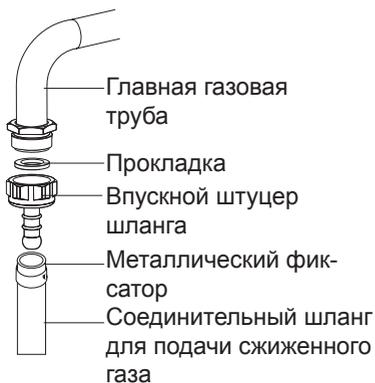
1. Для соединения сжиженного газа (цилиндр) прикрепите металлический фиксатор на шланг, идущий от цилиндра сжиженного газа. Подсоедините край шланга к впускному штуцеру, находящемуся за духовым шкафом, предварительно нагрев шланг в кипяченной воде. Затем установите фиксатор на конце шланга и затяните отверткой. Уплотнительный и впускной штуцер шланга, необходимый для подсоединения, показан на картинке ниже.
